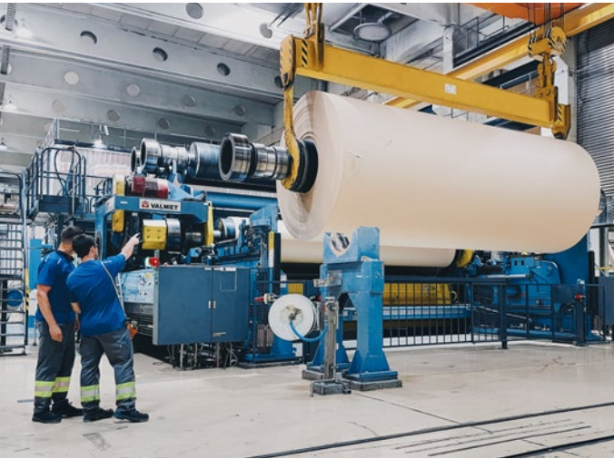
↑ Ein Tambour mit ungebleichtem Kraftpapier der neu umgebauten PM6 in Steyrermühl
