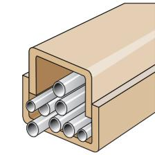
Aus zwei U-Profilen kann eine variable Langgutverpackung gemacht werden.
