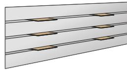
I-Profil als Schutzunterlage wenn geklammert oder getackert wird.
