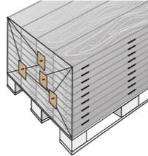
Mit I-Profilen kann die Ware gestützt und die Kanten der Ware bei der Lagerung geschützt werden.
