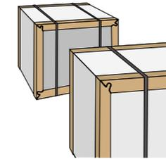
Durch das KLIK-Profil wird die Verpackung gestärkt und die Stapelfähigkeit der Ware erhöht.
