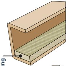
Die an den Rand vom U-Profil eingeklebte Polsterung hilft die herausragenden Teile des Produkts zu schützen.
