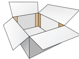
Kantenschutzleisten als Verstärkung der Ecken für höhere Stapelfähigkeit. Die Belastbarkeit und Stabilität des Kartons wird erhöht.
