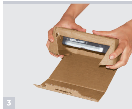
3 Die Verschlusszunge wird über die Laschen der Seitenteile gefaltet und verschlossen.
