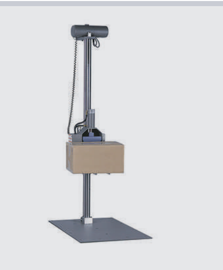
Fall Nr. 5 Maximal gemessener G-Wert: 51 G Fallseite: Fläche 5
