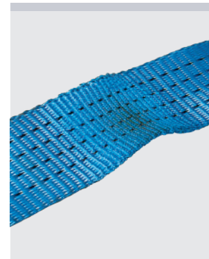
Verformung durch Wärme
