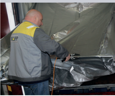
6. Climatainer mit der Alu-Wärmesiegelzange schließen – bis auf eine kleine Öffnung.
